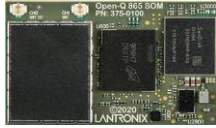
SOM with Core Processor QRB5165-SOM-A
